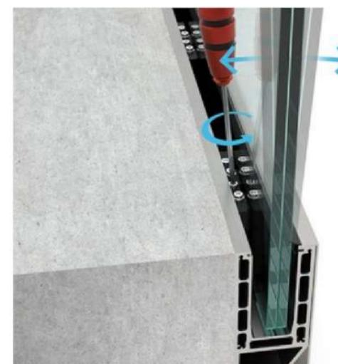
Das Erreichen einer perfekten Glasausrichtung ist einfach. Die beiden Schrauben ohne Unterlegscheibe neigen das Glas zu Ihnen, die beiden mit Unterlegscheibe neigen es in die entgegengesetzte Richtung. Wenn die perfekte Ausrichtung erreicht ist, ziehen Sie alle anderen Schrauben fest.
