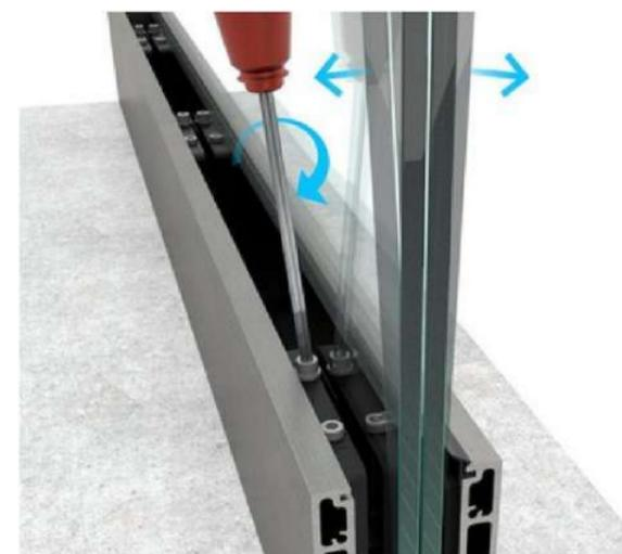
Um eine perfekte Ausrichtung zu erreichen, verwenden Sie die beiden Schrauben. Der erste neigt das Glas in Ihre Richtung, der zweite in die entgegengesetzte Richtung. Wenn die perfekte Ausrichtung erreicht ist, ziehen Sie beide Schrauben fest.
