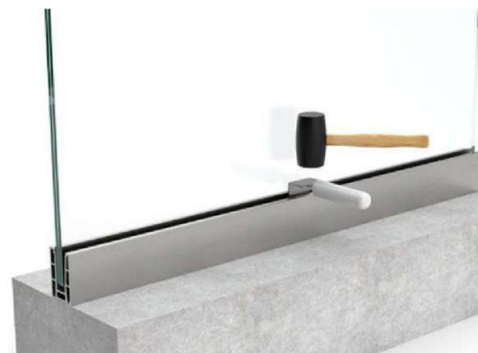
Sobald alle Keile angebracht sind, setzen Sie sie mit einem Keileinsetzer und einem Hammer ein, bis das Glas fest sitzt.
