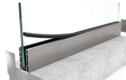
5. Bringen Sie die vordere Gummidichtung und die vorderen und hinteren Abdeckungen an.
