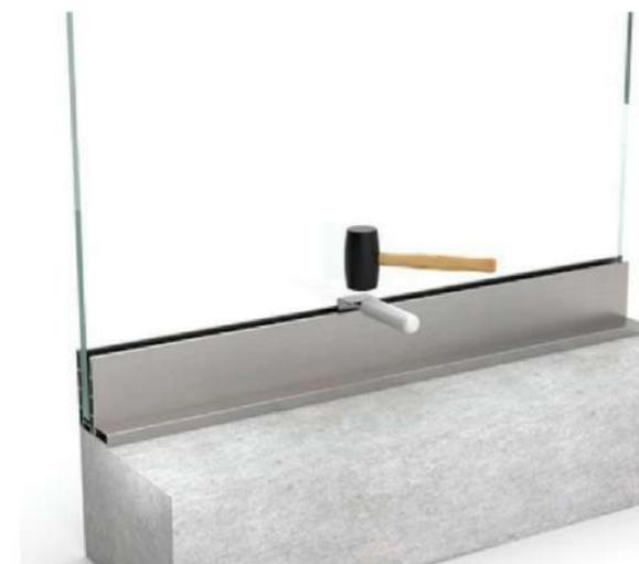
Sobald alle Keile angebracht sind, setzen Sie sie mit einem Keileinsatzer und einem Hammer ein, bis das Glas einrastet.
